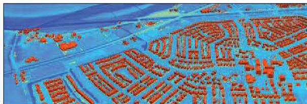
Met behulp van ArcGIS is een LOD1 3D-model gecreëerd door het combineren van de BAG en de gemiddelde hoogte van de puntenwolken.
